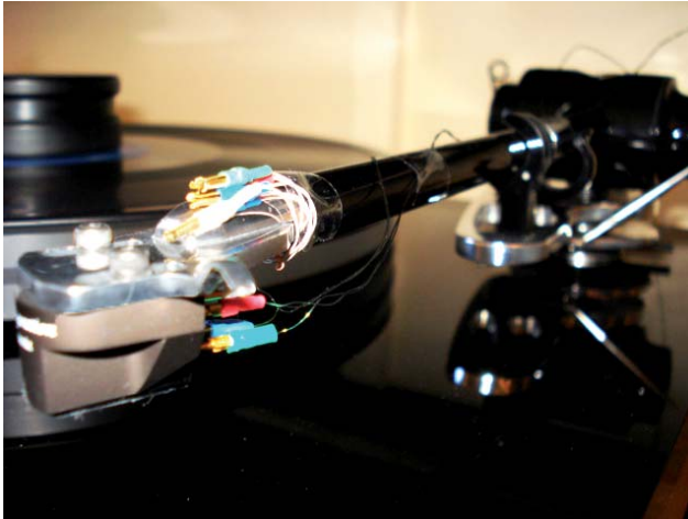
So "wild" sieht eine improvisierte Verkabelung aus - und trotzdem brummt nichts!
